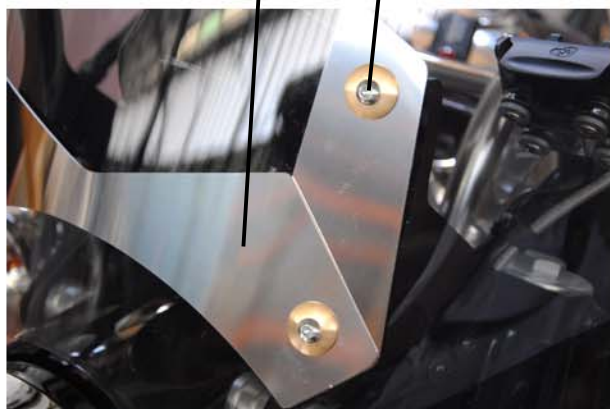
vite M6x25 + rondella bombata
