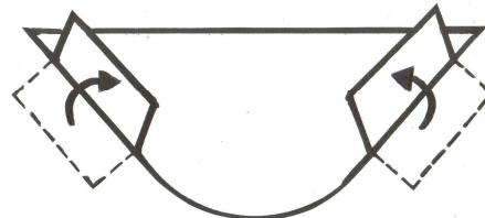
Il faut d'abord attacher les feuilles en aluminium sur les couvercles. Pour obtenir une bonne liaison adhésive entre les volets et la surface correspondante à l'intérieur du couvercle, idéalement utilisez une résine adhésive à deux composants ou une colle basée au solvant. L'adhérence peut être améliorée par un stratifié de crochet ou par la fixation avec des rivets.
