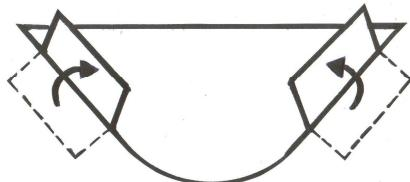
Das Dreieck-Blech wird zunächst unten im Deckel - etwas vertieft - eingeklebt. Hierzu bitte die Klebeflächen der umgebogenen Laschen und jene Fläche im Innern der Deckel aufrauen und für einen guten Haftverbund sorgen (= staub- und fettfrei). Bewährt hat sich 2-Komponenten Epoxi-Kleber aus dem Modellbau. Die Klebung der Laschen kann mit übergelegten Glasfaser-Streifen oder mit einer Nietenverbindung noch zusätzlich verstärkt werden.
