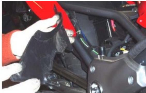
Ora passiamo alla parte anteriore: rimuovere le viti che fissano la plancia di plastica ai fianchetti anteriori (in base all'anno sono presenti 2 o 4 viti per ogni lato e una vite al centro della plancia, dietro alla forcella)
