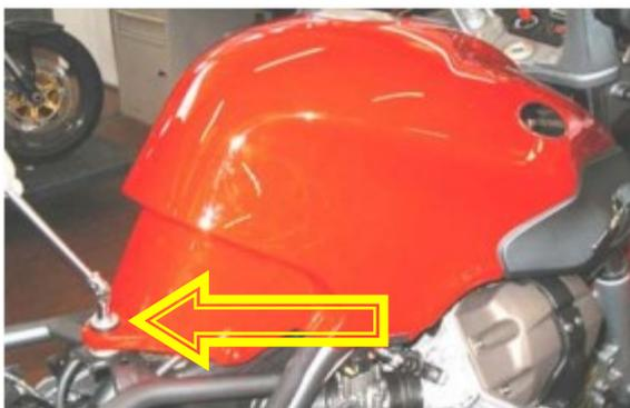
Ora togliamo la vite di fissaggio del serbatoio, a questo punto è possibile alzarlo per accedere alla zona airbox
