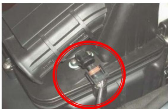
Il sensore sul quale si installa il V-Twin Boost è quello evidenziato di seguito:
