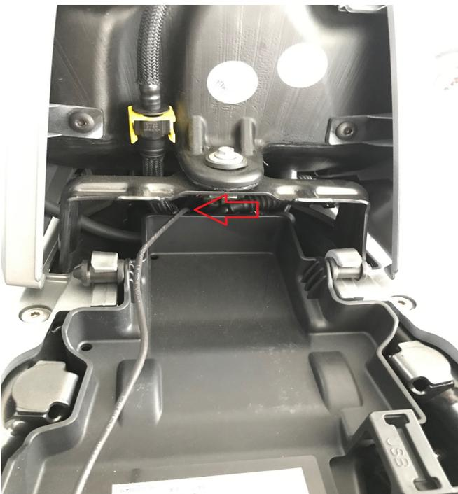
L'estremità del Vtwin Boost è la parte che permette l'analisi dei nuovi dati, per un corretto funzionamento del dispositivo è necessario posizionarla lontano dal calore generato dal motore. Abbiamo previsto l'installazione nel sottosella a cui è possibile rimandare l'estremità stessa attraverso gli spazi liberi al centro del telaio. In quella zona è possibile eseguire il fissaggio tramite la fascetta in dotazione.
